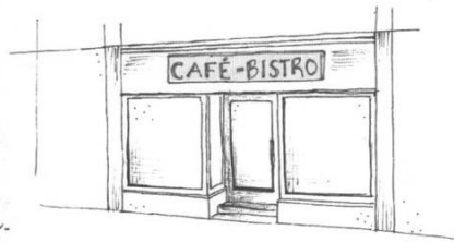
Enseigne posée à plat
